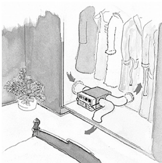
Lämmitetyn ulkoilman kierto tehostuu, kun tuloilmalämmitin asennetaan mahdollisimman alas.
