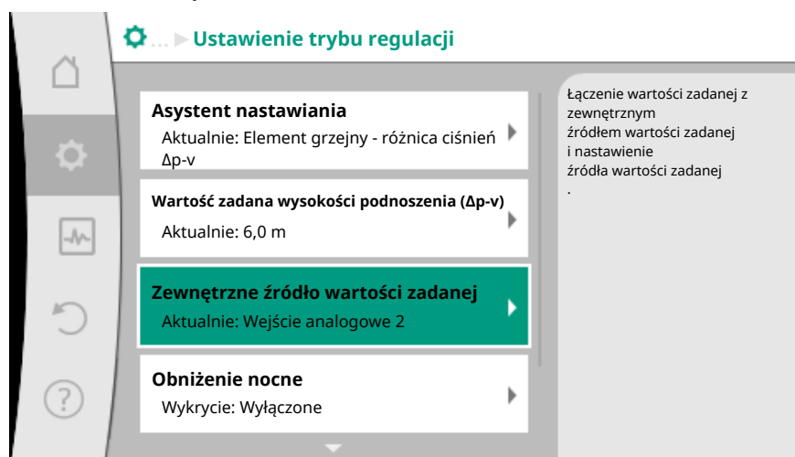
Fig. 66: Zewnętrzne źródło wartości zadanej
