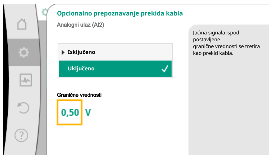
Fig. 72: Granična vrednost za prekid kabla
