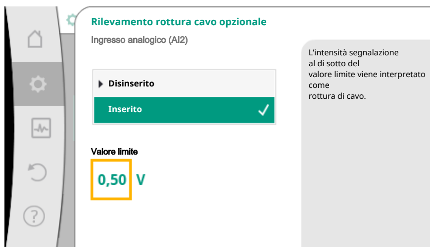
Fig. 72: Valore limite rottura di cavo
