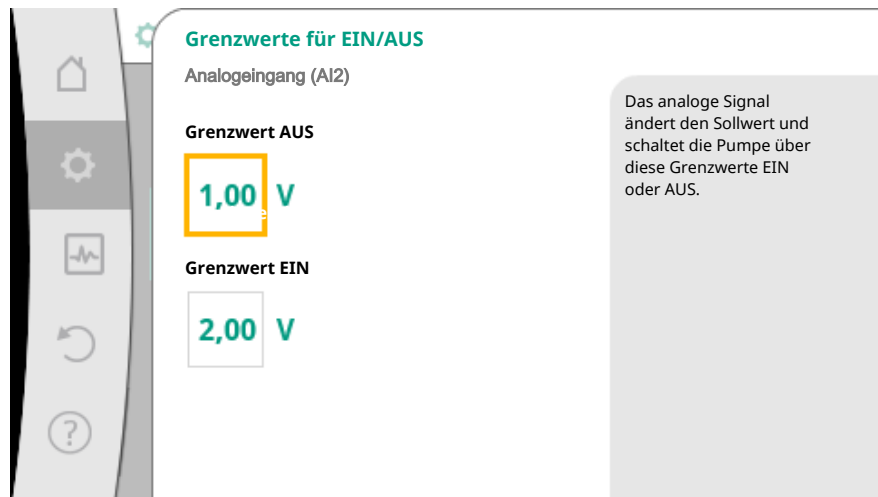
Fig. 74: Grenzwerte zur EIN/AUS-Steuerung über Analogsignale
