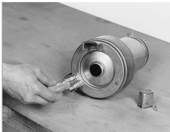
DX50 (Micro 7G): Avaa hylsyavaimella jalkojen ruuvit.
