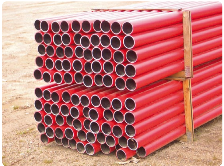
Kuva 2. Oikea tapa varastoida niput. Kehikot laitetaan päällekkäin.
