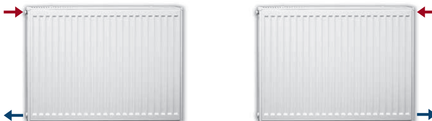
Päätykytkentä samassa päädyssä
