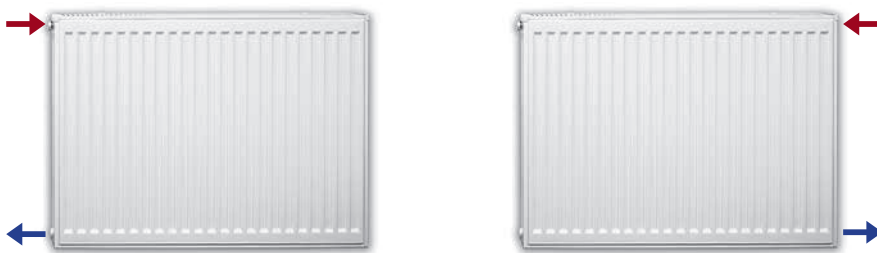
Päätykytkentä samassa päädyssä
