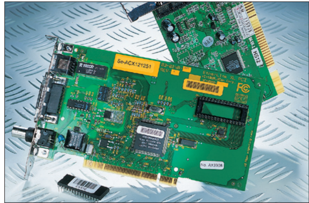
Helatag 823-etiketit - luotettava komponenttien ja piirilevyjen merkintä.
