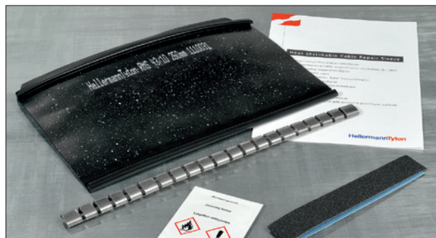
RMS-pakkaus sisältää: kaapelin korjauskääreen, haponkestävän teräskiskon (SS316) kääreen sulkemiseen, hiontapaperin, puhdistuspyyhkeen ja asennusohjeen.
