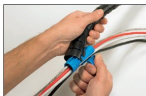
Aseta asennustyökalu Helawrap-sidontaspiraalin toiseen päähän.
