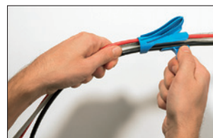
Asenna yksi tai useampi kaapeli työkaluun.
