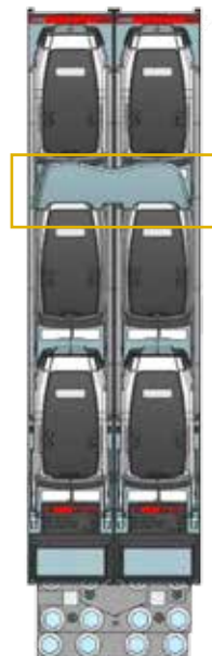
Kuvassa kaksi kytkintä liitetty yhteen liitossarjan ZLBM23-3Px2KIT (36 404 24) avulla.
