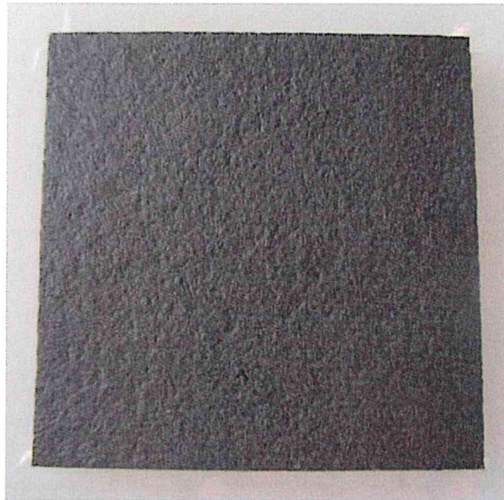
Foto 1: Untersuchungsmaterial Insul sheet/ roll 6mm, Farbe schwarz nach einer Inkubationszeit von 28 Tagen ohne sichtbaren Pilzbewuchs
