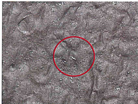
Foto 2: Untersuchungsmaterial Insul sheet/ roll 6mm, Farbe schwarz nach einer Inkubationszeit von 28 Tagen mit geringem Pilzwachstum (50fach vergrößert)
