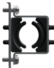
Kannake sovitettuna LK Jakotukkia UNI G20 ja putkikokoa 20-22 mm varten.
