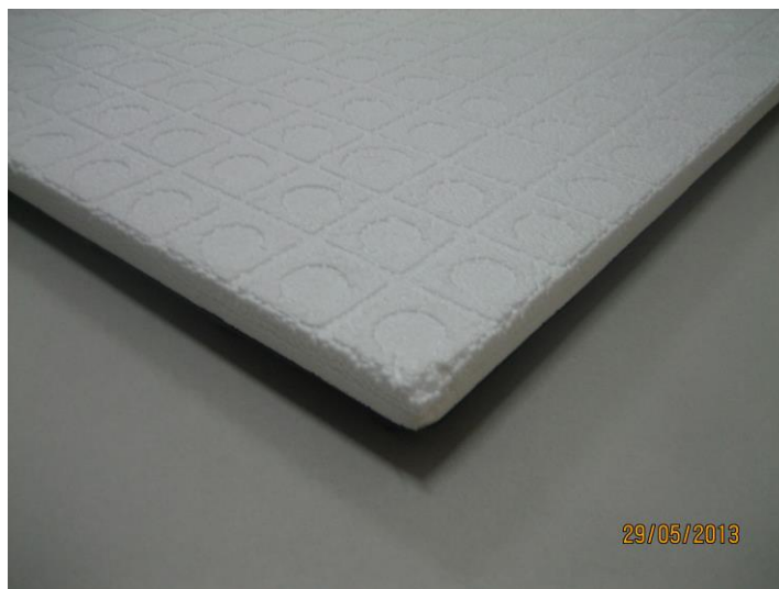
Kuva 2 : Sejotek EPS- askeläänieristeen alapinta
