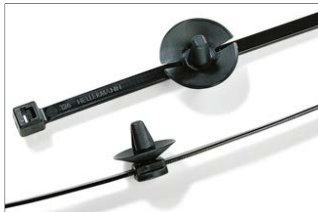
Kiinnitysankkurin aluslevy estää lian ja kosteuden sisään tunkeutumisen.
