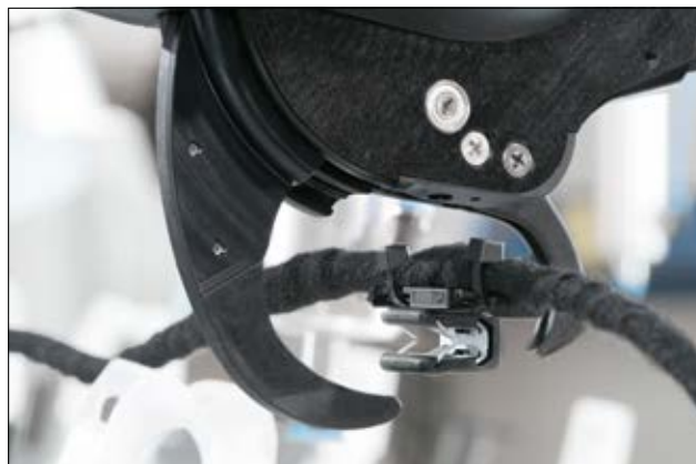
Reunakiinnitysankkuri automaattiselle sidontajärjestelmälle.
