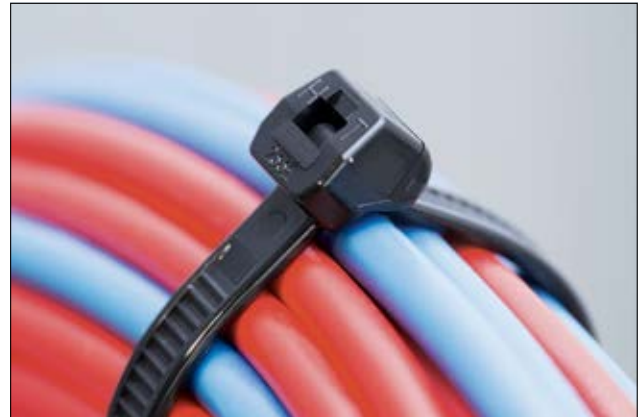
OS-sarjan johdinsiteissä hammastus on sidenauhan ulkopuolella ja sidenauhan sileä sisäpinta ei vaurioita johtimien eristeitä.
