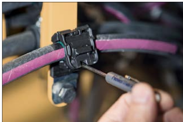
RC-sarjan kaapelikiinnike, monipuolisempi kuin tavallinen P-kiinnike.
