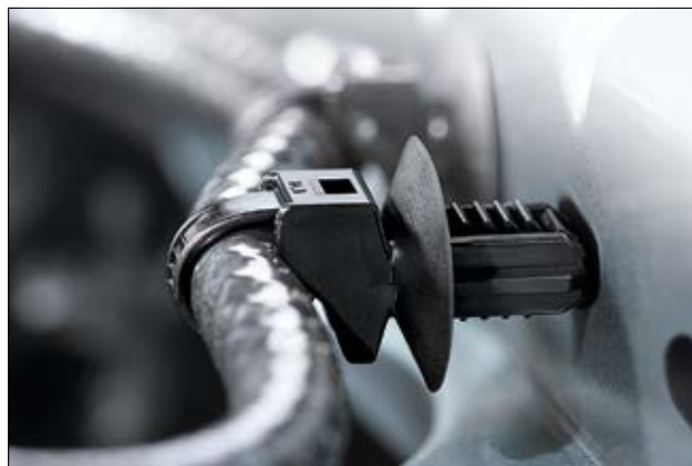
Johdinsiteet pikakiinnitysankkurilla ja aluslevyllä soikeisiin kiinnitysreikiin.
