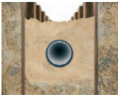
kaivamalla tehtävä asennus hiekkapedillä
