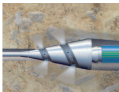
kaivamaton (no-dig) asennus, kuten suuntaporaus sekä pakko- ja pitkäsujutus
