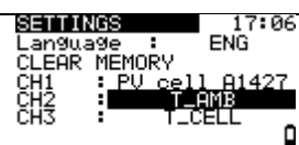
Kuva 4-5: Lämpötila-anturin valinnan käyttö
