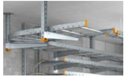
Profiilikannakkeeseen US 5 kiinnitetään AW 30 kannake ruuvisarjalla SKS 10x90 ja väliin asennetaan DSK 45 tukikappale. Tikashylly kiinnitetään AW 30 kannakkeeseen LKS 40 kiinnityskappaleella.
