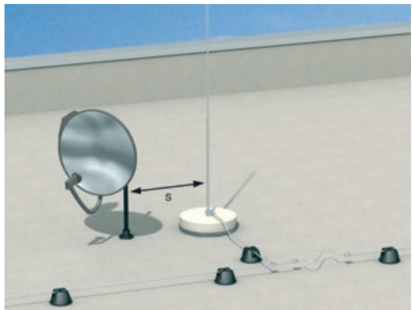
Katolla olevan sieppaustangon ja lautasantennin välinen erotusväli S.
