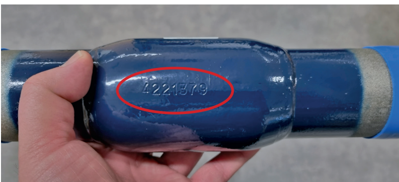
Kuva 2. Leimanumero venttiin runkoputkessa/ Figure 2. Stamp number on the valve body pipe
