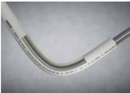
Kuva 27: Putken taivuttaminen taivutusjousella.
