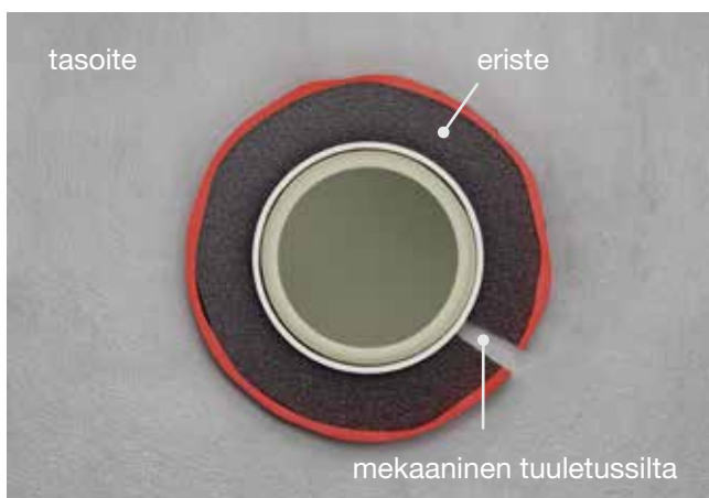
Kuva 41: Mekaaninen tärinänlöpäisy viallisen putkieristyksen kautta.
