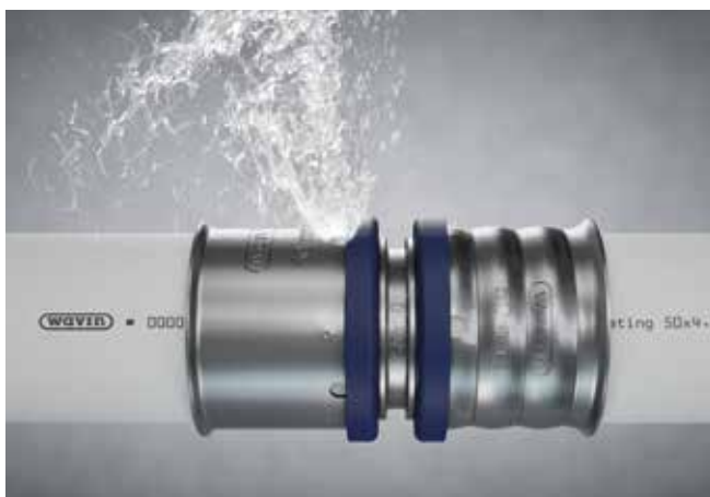
Kuva 16: DLF (Defind Leak Function) paljastaa painetestissä puristamattomien liitännöjen vuodot.
