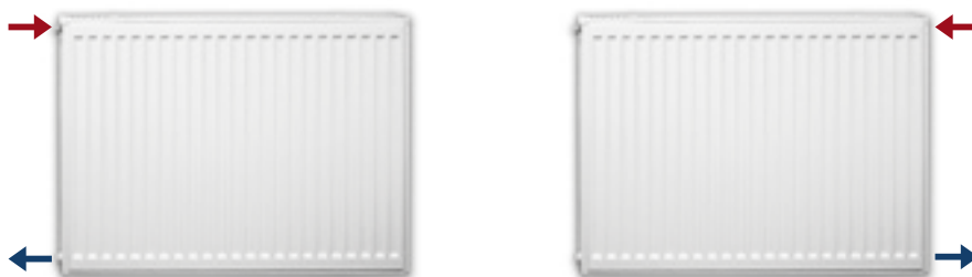
Päätykytkentä samassa päädyssä
