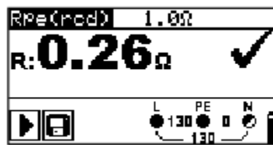
Kuva 5.40: Esimerkit PE-johdinten jatkuvuuden mittaustuloksista
