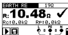
Kuva 5.35: Esimerkki maadoitusvastuksen mittaustuloksista
