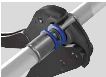
Kuva 26: Puristusleukojen kohdistaminen Tigris K1 -liittimessä.
