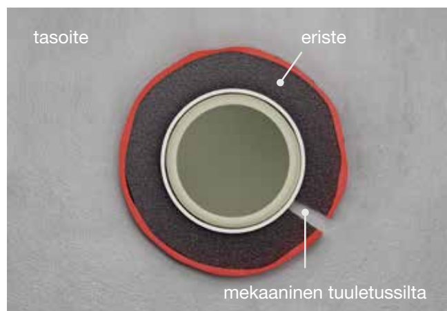
Kuva 41: Mekaaninen värinänläpäisy viallisen putkieristyksen kautta.
