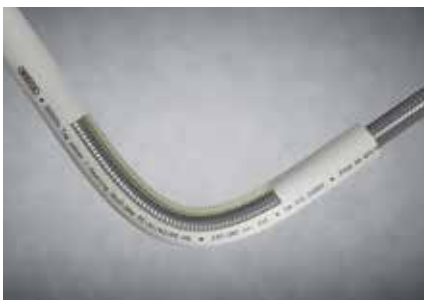
Kuva 27: Putken taivuttaminen taivutusjousella.
