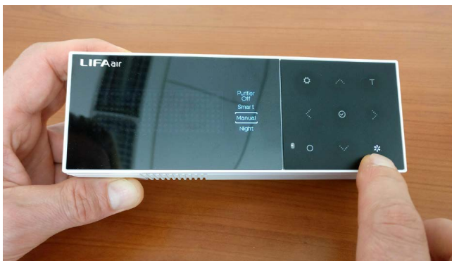
LA330 – automaattinen ohjaus sisäilman laadun mukaan
