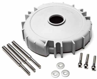
Diffuusorisarja , joka sisältää diffusorin, kuusiokantaruuveja, aluslevyjä, holkkimuttereita ja asennusohjeet.
